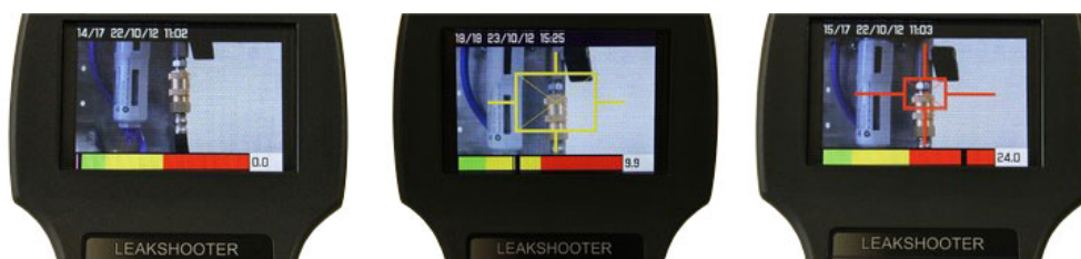
(fot.5 Wskazanie lokalizacji wycieku w oparciu o natężenie ultradźwięków)
